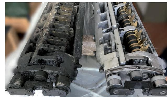
sopra: prima e dopo. Intervento di revisione con smontaggio, pulizia, sostituzione particolari usurati o rotti, riassetto e revisione
